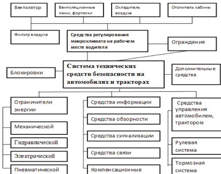
Рисунок 1-Классификационная схема технических средств безопасности, установленных на автомобилях и тракторах
