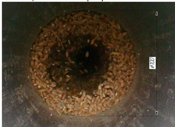
Рис. 3 – Распределение зерновой массы в кожухе при вертикальном транспортировании
