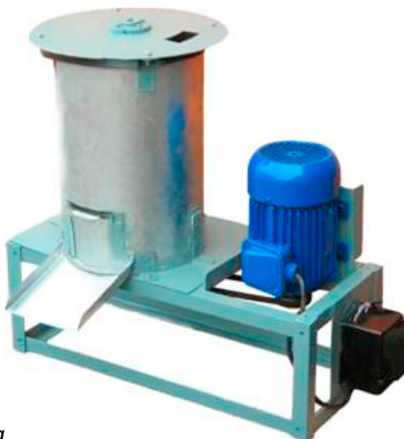
Рис. 1 – Смеситель кормов: а) схема; б) общий вид:
