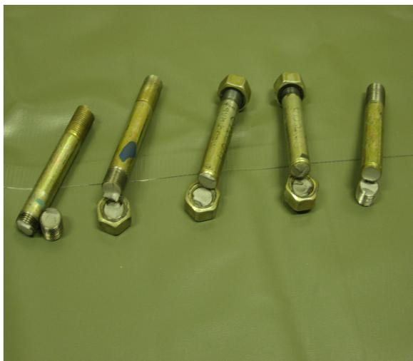
Рис. 6 – Образцы после усталостного разрушения
