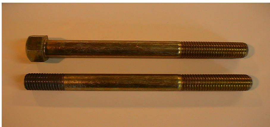
Рис. 1 - Фрагменты образца и шпильки для усталостных испытаний
