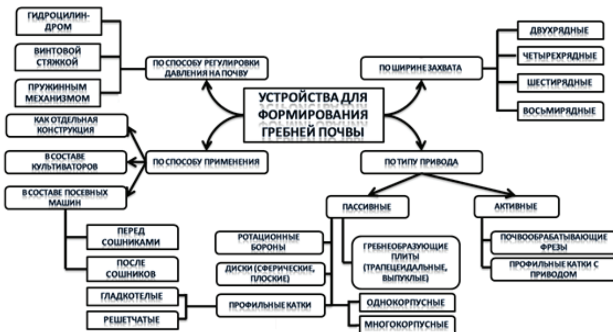
Рисунок 4 – Классификация устройств для формирования гребней почвы
