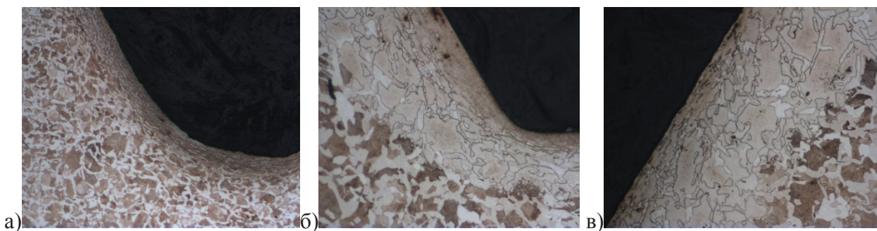
Рисунок 1 – Микроструктура витков резьбы после отделочно-упрочняющей электромеханической обработки: а – метрическо-коническая резьба переходника насосно-компрессорной трубы нефтедобывающего оборудования (сталь 40ХГМ); б - впадина и в) боковая поверхность замковой резьбы 3-102 буровой трубы.
