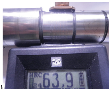
Рисунок 2 - Фрагмент измерения твердости до (а) и после (б) восстановления
