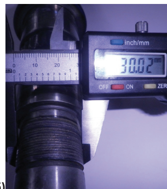
Рисунок 3 - Фрагмент изменения диаметра вала до (а) и после (б) восстановления
