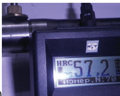
Рисунок 2 - Фрагмент измерения твердости до (а) и после (б) восстановления
