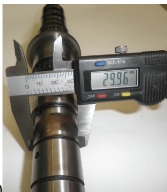
Рисунок 3 - Фрагмент изменения диаметра вала до (а) и после (б) восстановления
