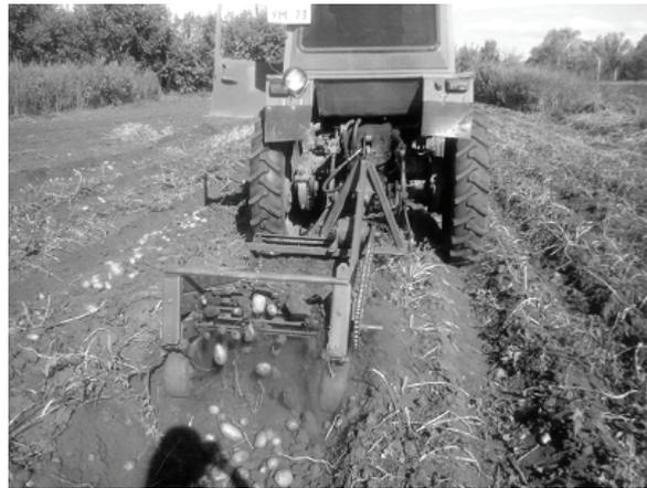
Рисунок 2 – Производственные испытания однорядной картофелекопалки
