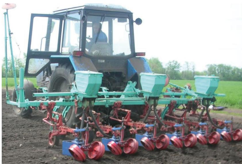
Рис. 1 – Гребневая сеялка, оснащенная предлагаемыми сошниками
