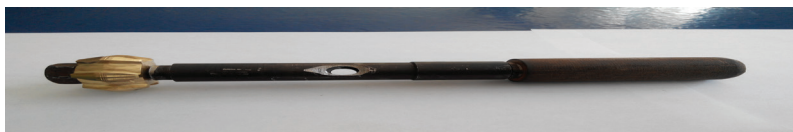
Рисунок 2 – Общий вид инструмента для электромеханической закалки рабочих поверхностей шлицевых втулок
