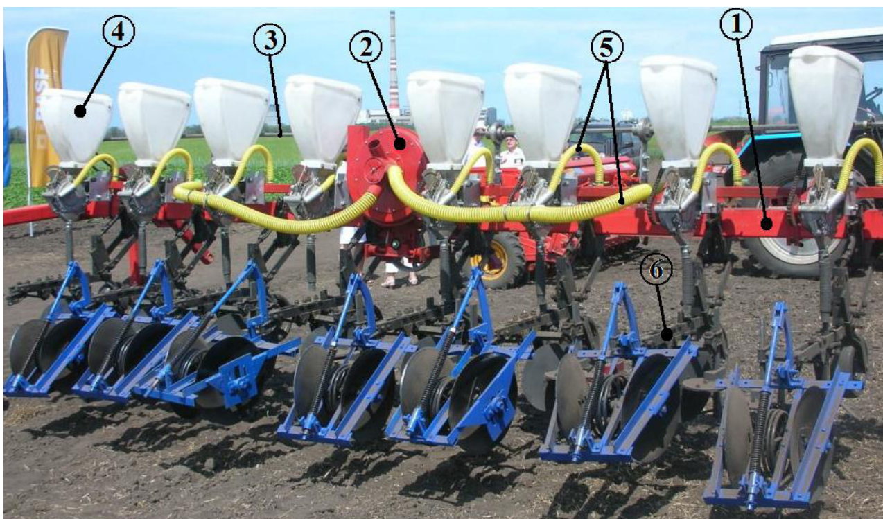
Рис. 1 – Комбинированный посевной агрегат: 1 – рама; 2 – вентилятор; 3 – приводной вал; 4 – семенной ящик с высевальными аппаратами; 5 – воздухопроводы; 6 – секция
