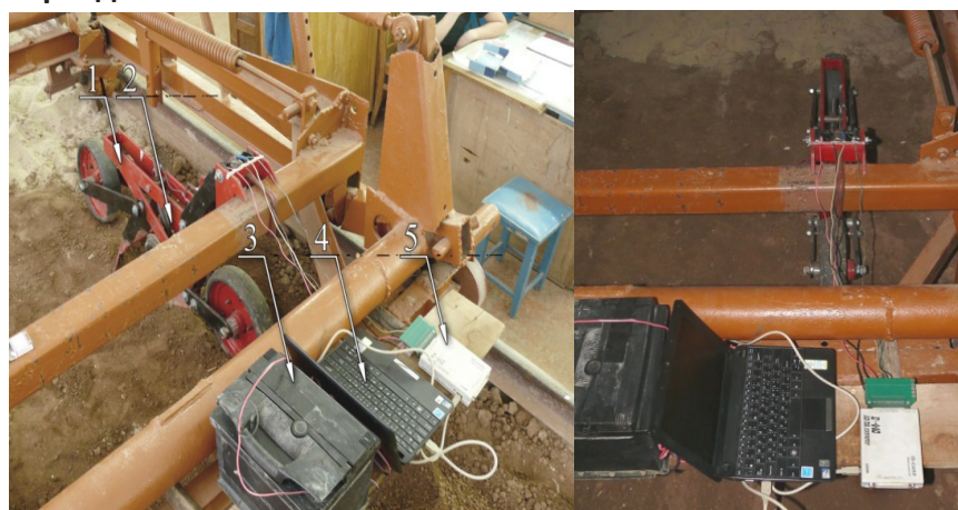
Рис. 2 – Общий вид экспериментальной установки и измерительного оборудования: 1 – посевная секция; 2 – датчик; 3 – аккумуляторная батарея; 4 – ноутбук; 5 – измерительный модуль E-440
